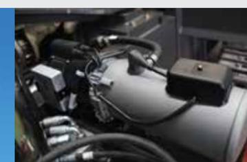
**Электрическая система предварительного нагрева**
