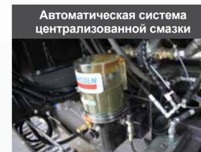
**Автоматическая система централизованной смазки**
